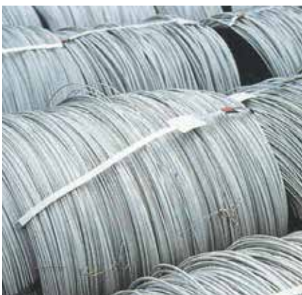
PERMINOX®-Edelstahlbewehrungen werden ab Coil und ab Stäben verarbeitet.
