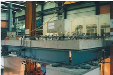
Átszúródási kísérletek EPFL Luiziana (2000) Punching shear tests at EPFL Lausanne (2000)
